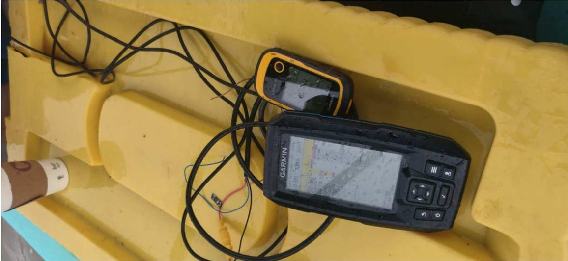
*Instrumental utilizado para la medición de batimetría*
