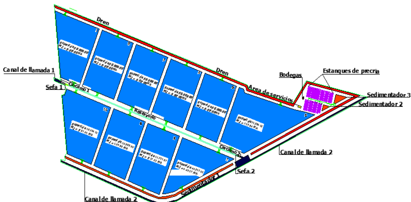
Imagen.- Vista de la infraestructura de la granja.
