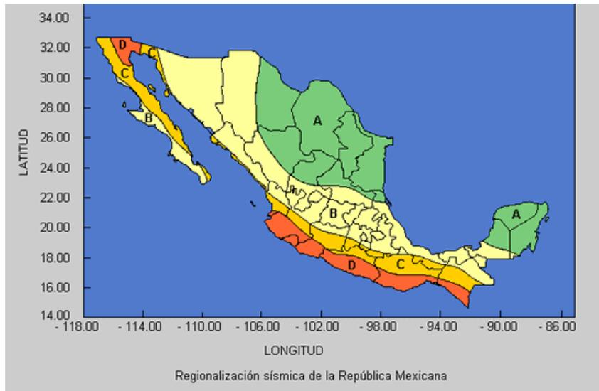
Figura IV-3 Regiones sísmicas de México Fuente: CFE. Manual de diseño de obras civiles. Instituto de Geofísica de la UNAM. El punto en rojo representa una aproximación del sitio donde se localiza el proyecto.
