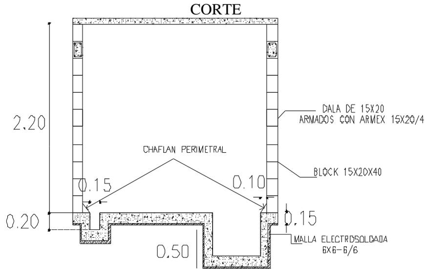
Imagen No. 13.- Diseño del almacén temporal de residuos peligrosos.
