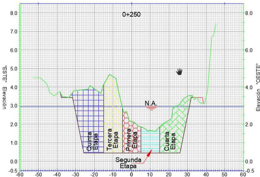
Imagen No. 7.- Sección de extracción típica.
