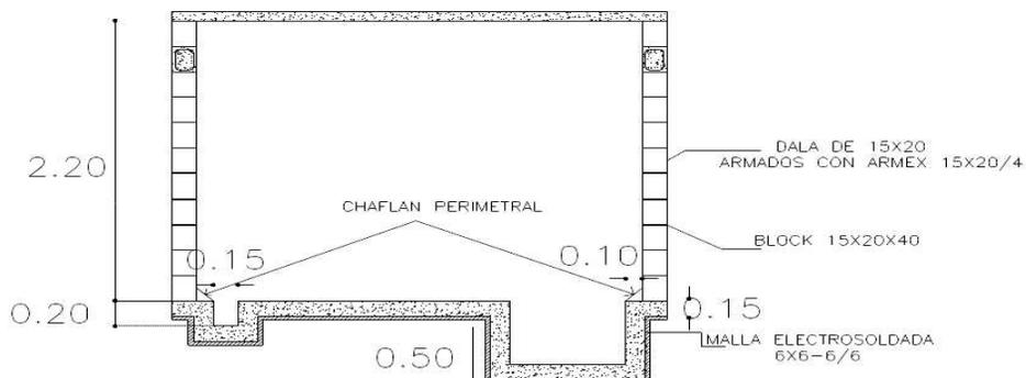
Imagen No. 12.- Diseño del almacén temporal de residuos peligrosos.
