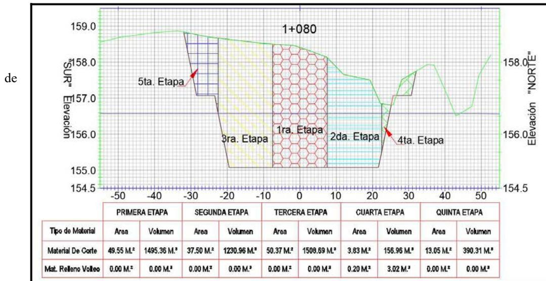
Imagen No. 7.- Sección extracción típica.
