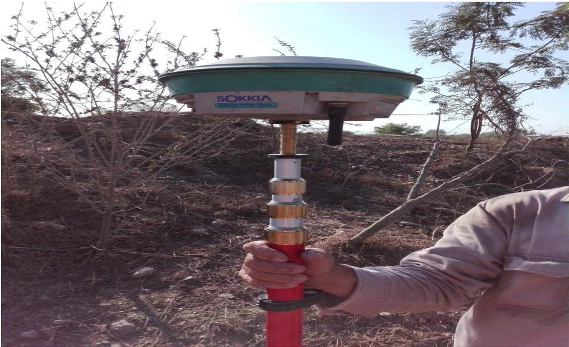
Imagen 20. Instrumento utilizado para el levantamiento topográfico.
