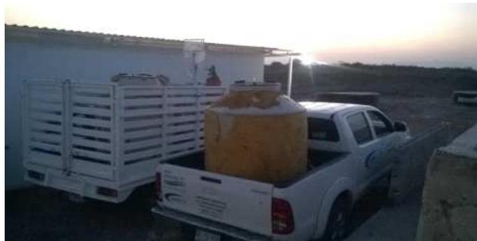
Las postlarvas son transportadas en recipientes de rotoplas con capacidad de 1000 litros de agua, recubierto con poliuretano que actúa como un aislante térmico para mantener la temperatura que las postlarvas requieren.
