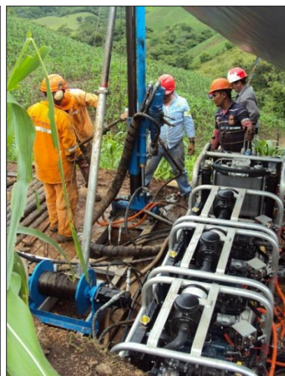
Ilustración 18 Equipos portátiles hidráulicos de perforación a diamante similares, durante su instalación (izquierda) y durante su operación (derecha).
