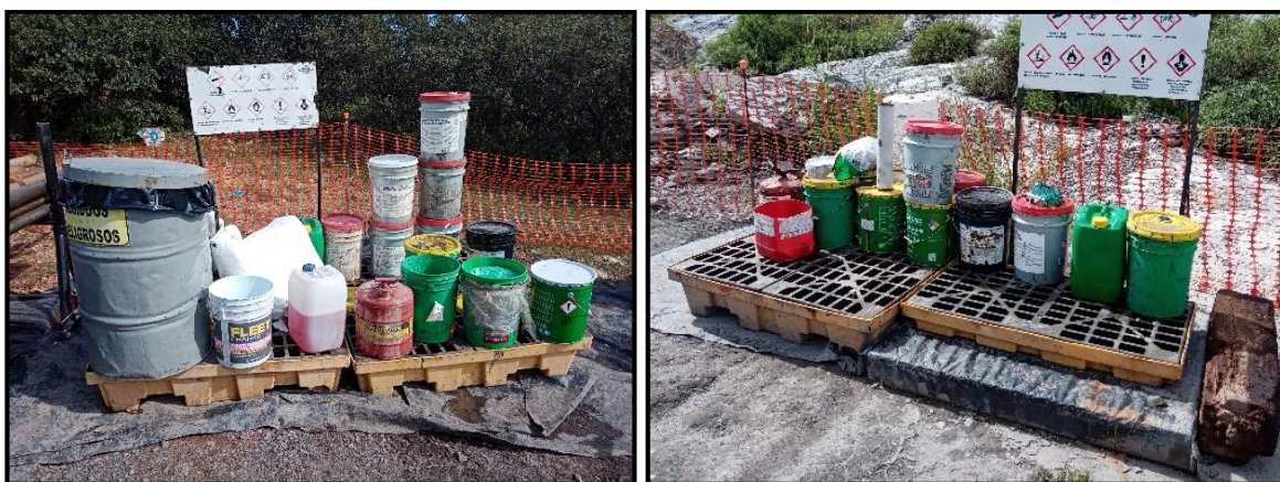
Ilustración 6 Áreas de almacenamiento de aditivos, grasas, aceites, combustibles y RP en las áreas de operación.
