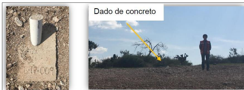
Ilustración 10 Dado de concreto que se sella la planilla de barrenación (foto archivo).
