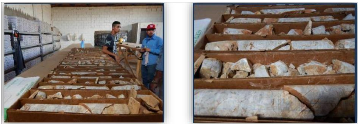
Ilustración 13 Núcleo obtenido por barrenación a diamante (foto archivo).
