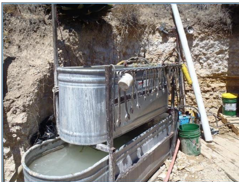
Ilustración 12 Decantación y recirculación del agua (foto de archivo).
