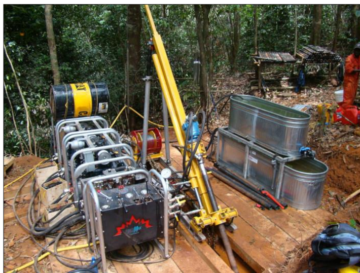
Ilustración 18 Equipos portátiles hidráulicos de perforación a diamante similares, durante su instalación (izquierda) y durante su operación (derecha).
