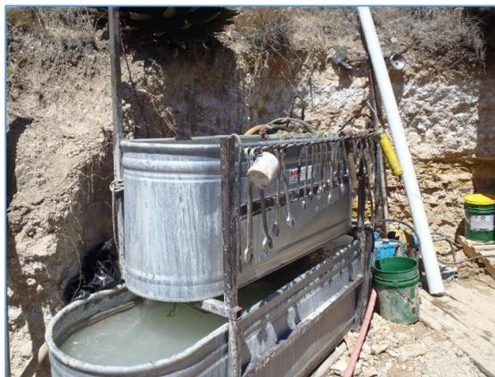
Imagen 4 Decantación y recirculación del agua
