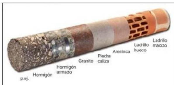
Imagen 8 Testigo producto de perforación con diamante
