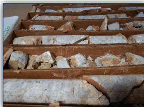
Imagen 5 Núcleo obtenido por barrenación a diamante
