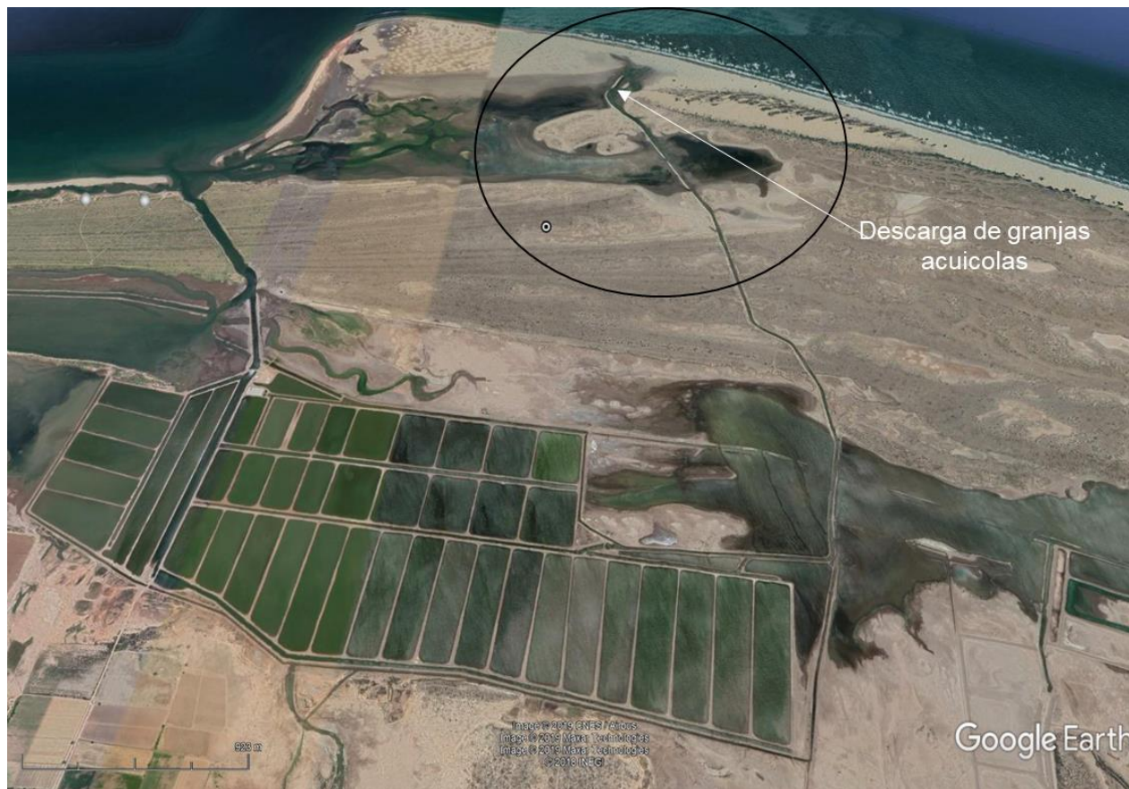
Imagen 2.- La liberación de aguas de desecho con sedimentos y nitrógeno en el Estero Santa Bárbara, lo azolva y eutrofiza.
