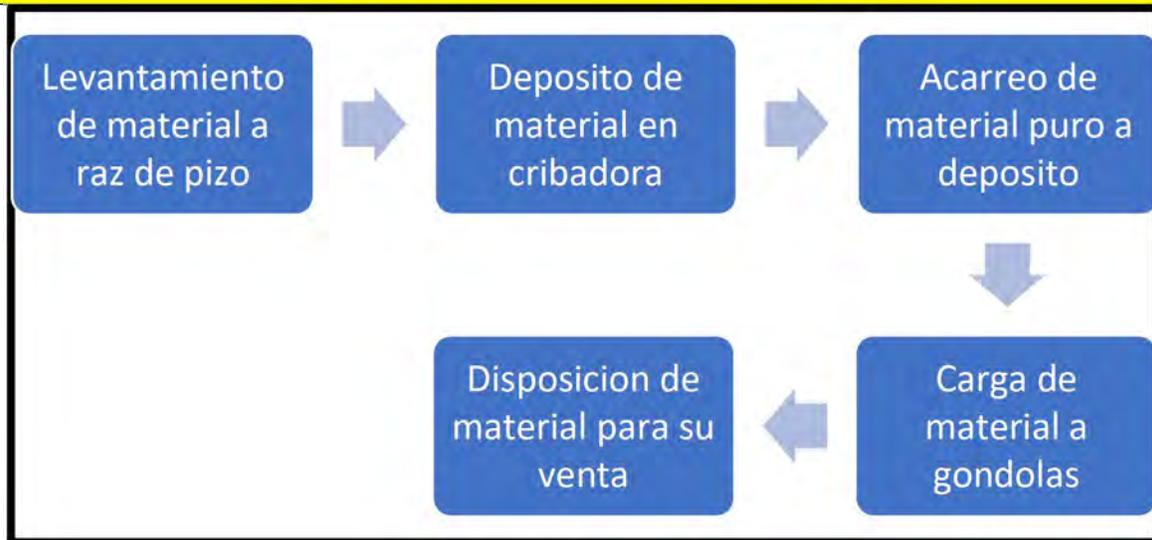
FIGURA 9: DIAGRAMA DE PROCESO PARA LA EXTRACCION
