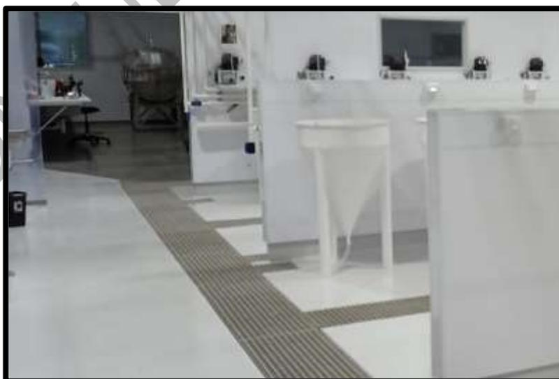
Figura 22. Tanque de incubación en V (VIC).
