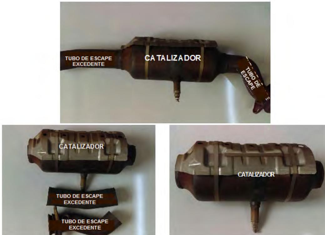
Figura 2.5. Partes que conforman el catalizador
