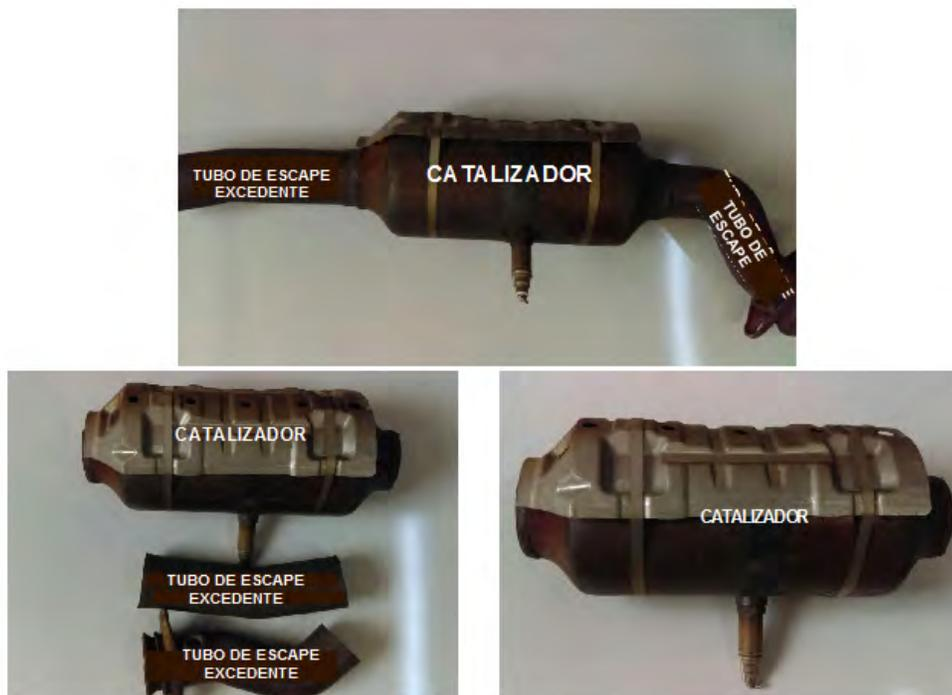
Figura 2.5. Partes que conforman el catalizador
