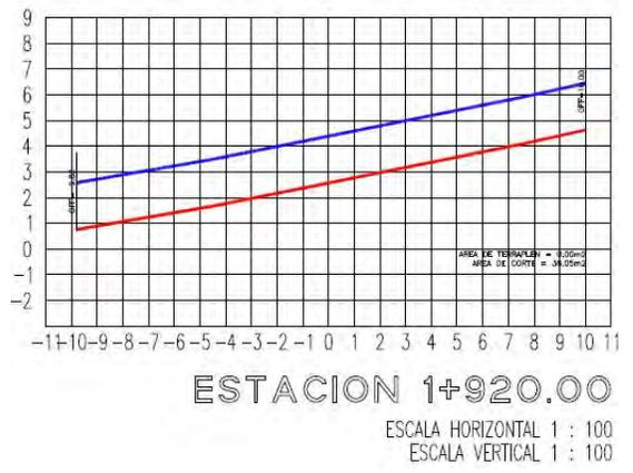
Figura 23.- Sección transversal del banco D (estaciones 1+720 a 1+920), se indica área de corte.
