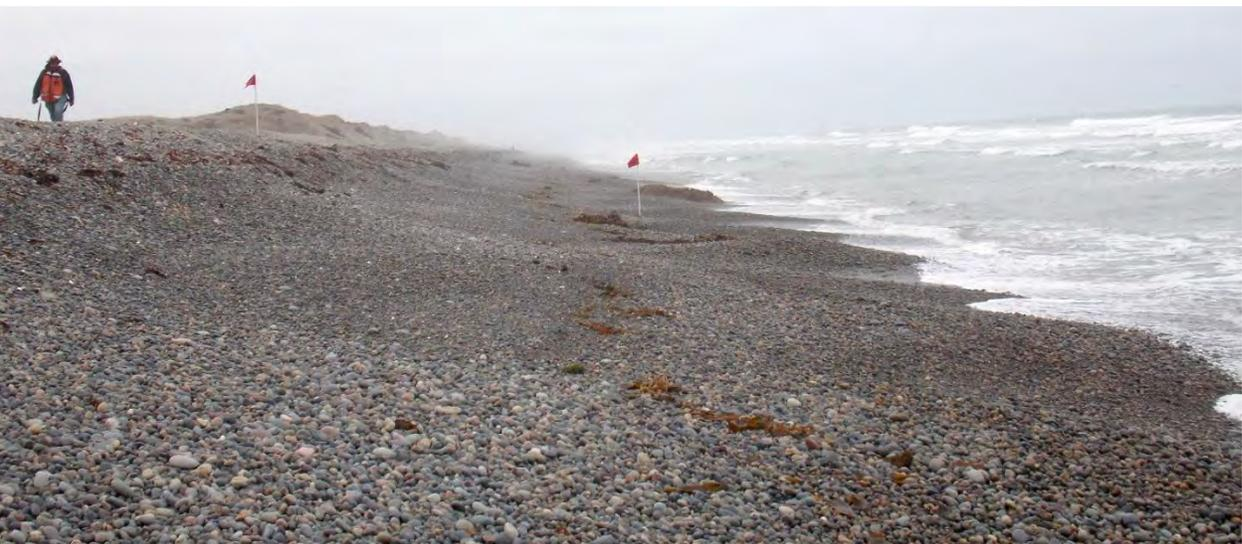
**Figura 6.-** Fotografía panorámica del banco D (Cañón San Vicente). Se puede apreciar que el material está compuesto principalmente por canto rodado en la Zona Federal de Playa.
