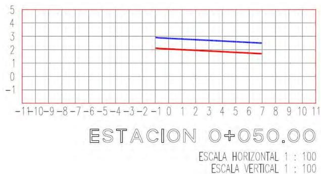
Figura 12.- Secciones transversales del banco B (estaciones 0+000 – 0+050), se indican áreas de corte.
