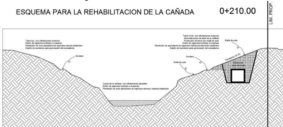
Se reconfigurará el talud de la cañada y se mejorará el suelo, mezclando material superficial del talud con tierra vegetal y se protegerá con malla de yute, para reducir la probabilidad de deslaves. Enseguida, se plantará vegetación nativa de las especies previamente existentes.
