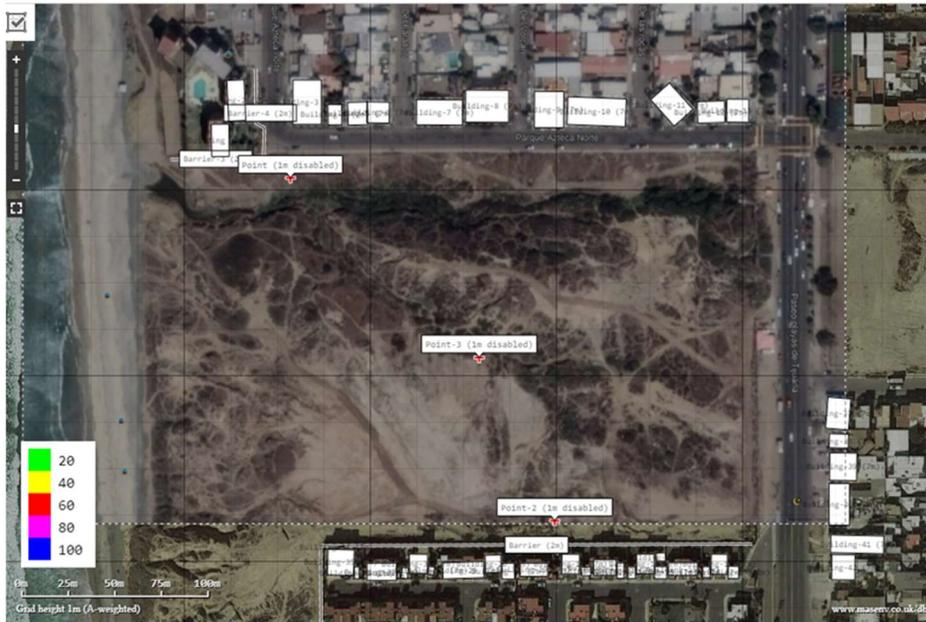
Para ejemplificar la anterior tabla, se realizó una simulación considerando el pico de 111 dB (A) de ruido en el terreno. La herramienta utilizada es Noise tools de MAS Enviromental Ltd. En primer lugar se construyeron las instalaciones cercanas al sitio.
