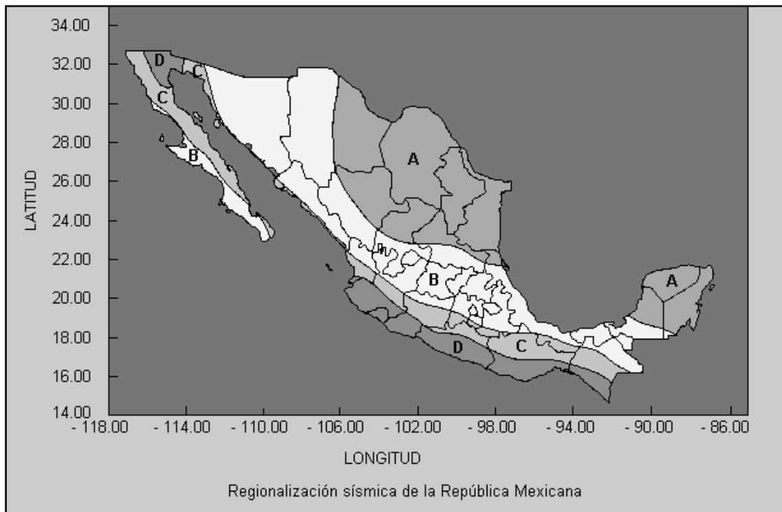
Figura IV.6. Ubicación del proyecto, en la Regionalización sísmica de la República Mexicana (www.ssn.unam.mx).
