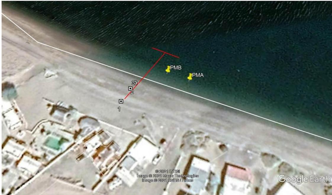
El muelle debe de ser construido hasta por lo menos las coordenadas 251029.05 m E, 3210117.81 m N, con una longitud entre 50 y 60 metros de longitud a la "T".
