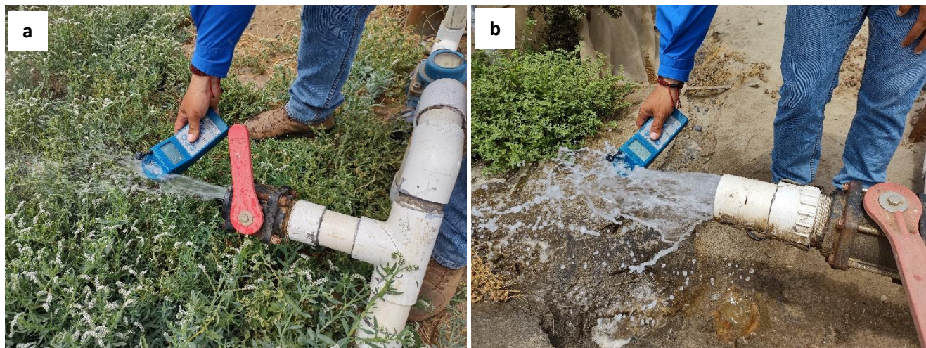
Foto 22. Se muestra el momento de la toma de muestra para analizar la calidad del agua a través de un salinometro Ultrameter II Serie 6275041 para el pozo 1 (a) y pozo 10 (b).
