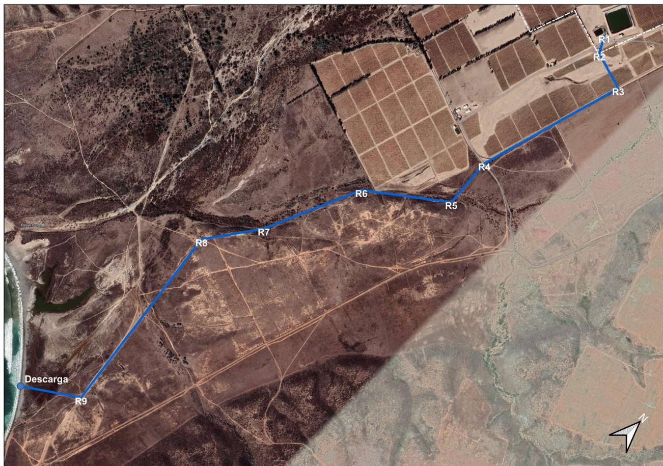
Figura 4. Imagen satelital que muestra la línea de la tubería del agua de rechazo desde la planta desaladora (R1) hasta el punto de descarga en la Bahía Colón. En la tabla 3 se presentan las coordenadas de los vértices de esta obra.
