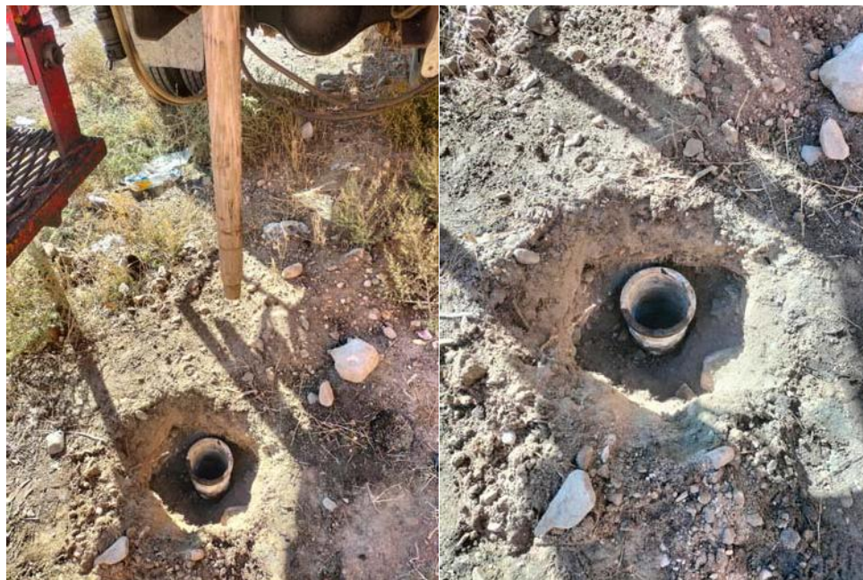
Figura 3.4. Vista de ejecución de prueba de permeabilidad
