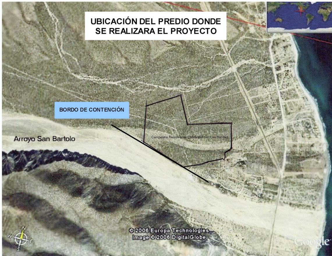
Fotografía No. 1.- Fotografía satelital de ubicación del predio, donde se pretende llevar a cabo el proyecto Campestre Residencial Colina del Sol, Los Barriles, en la misma fotografía se marca el sitio donde se llevara a cabo la construcción de un bordo de contención que protegerá el área del proyecto futuros escurrimientos en lluvias extraordinarias.
