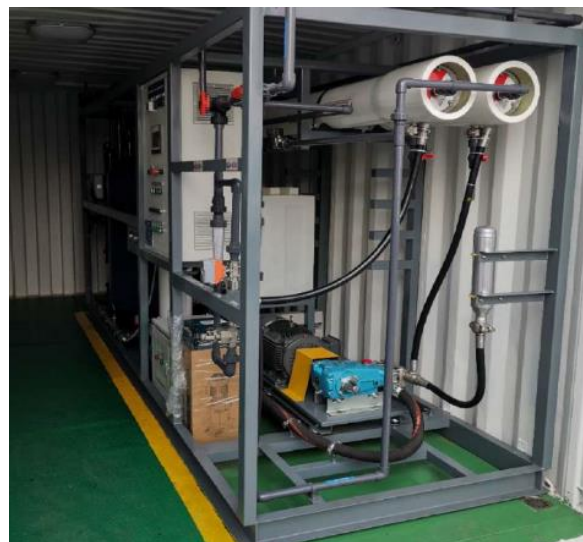
Ilustración 1 Vista isométrica del Skid donde se montan los componentes que integran la planta desaladora de 20 m3
