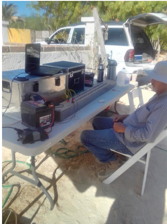
Foto 1 Resistivimetro utilizado para las tomografías
