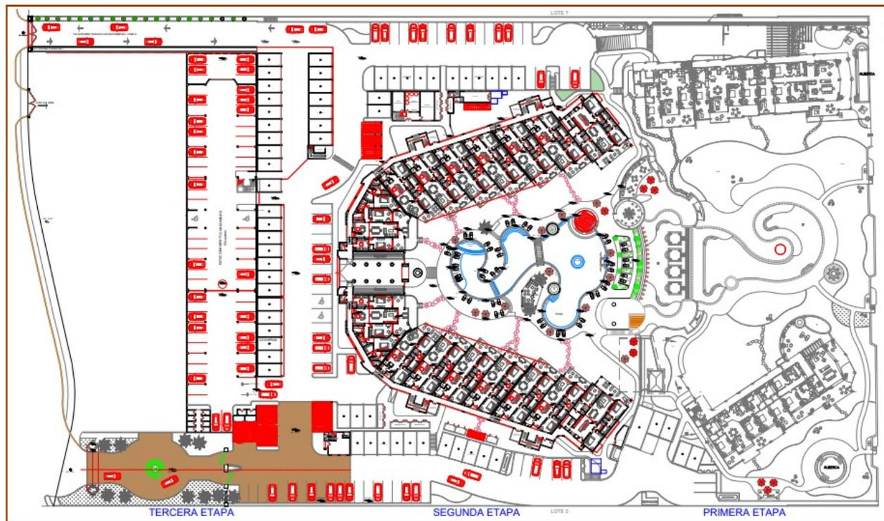
Figura 14.- Áreas construidas (proyecto autorizado) y áreas no construidas (en solicitud de autorización), divididas en etapas: la primer etapa corresponde a las edificaciones existentes y la segunda y tercer etapa a las que se someten a evaluación mediante esta manifestación de impacto ambiental.
