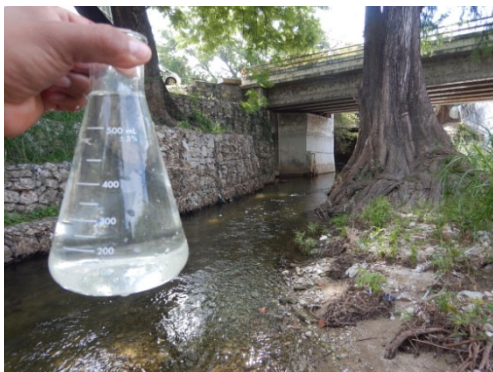
Imagen IV.1. Vista de la calidad del agua, 1), se observa la escasa turbiedad del agua sobre el río, 2) se observa rastros de grasas el cauce del río Sabinal
