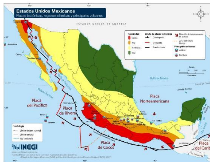
Figura 29. Interacción de las Placas Tectónicas en la República Mexicana.
