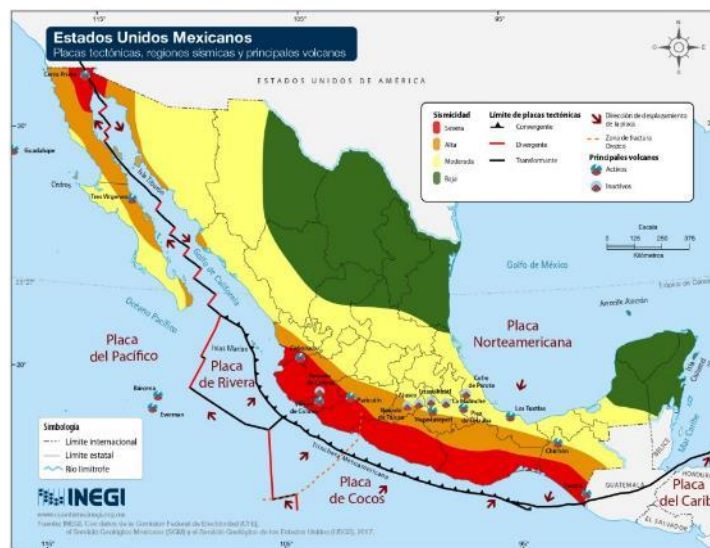
Figura 23. Interacción de las Placas Tectónicas en la República Mexicana.
