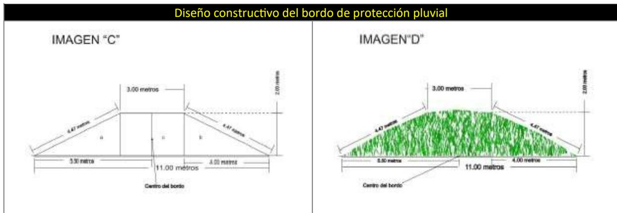
Diseño constructivo del bordo de protección pluvial
