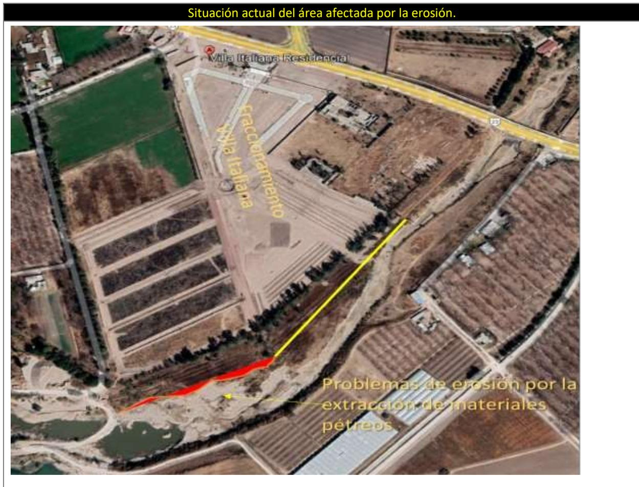
En la siguiente imagen se muestra gráficamente el nivel de deterioro del suelo ocasionado por la erosión hídrica, pero principalmente por la extracción de materiales pétreos que ha originado la socavación del sitio colindante con el fraccionamiento.
