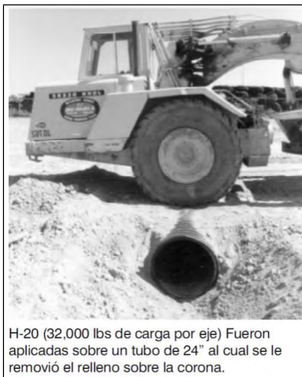
Figura II-14. Resistencia del material
