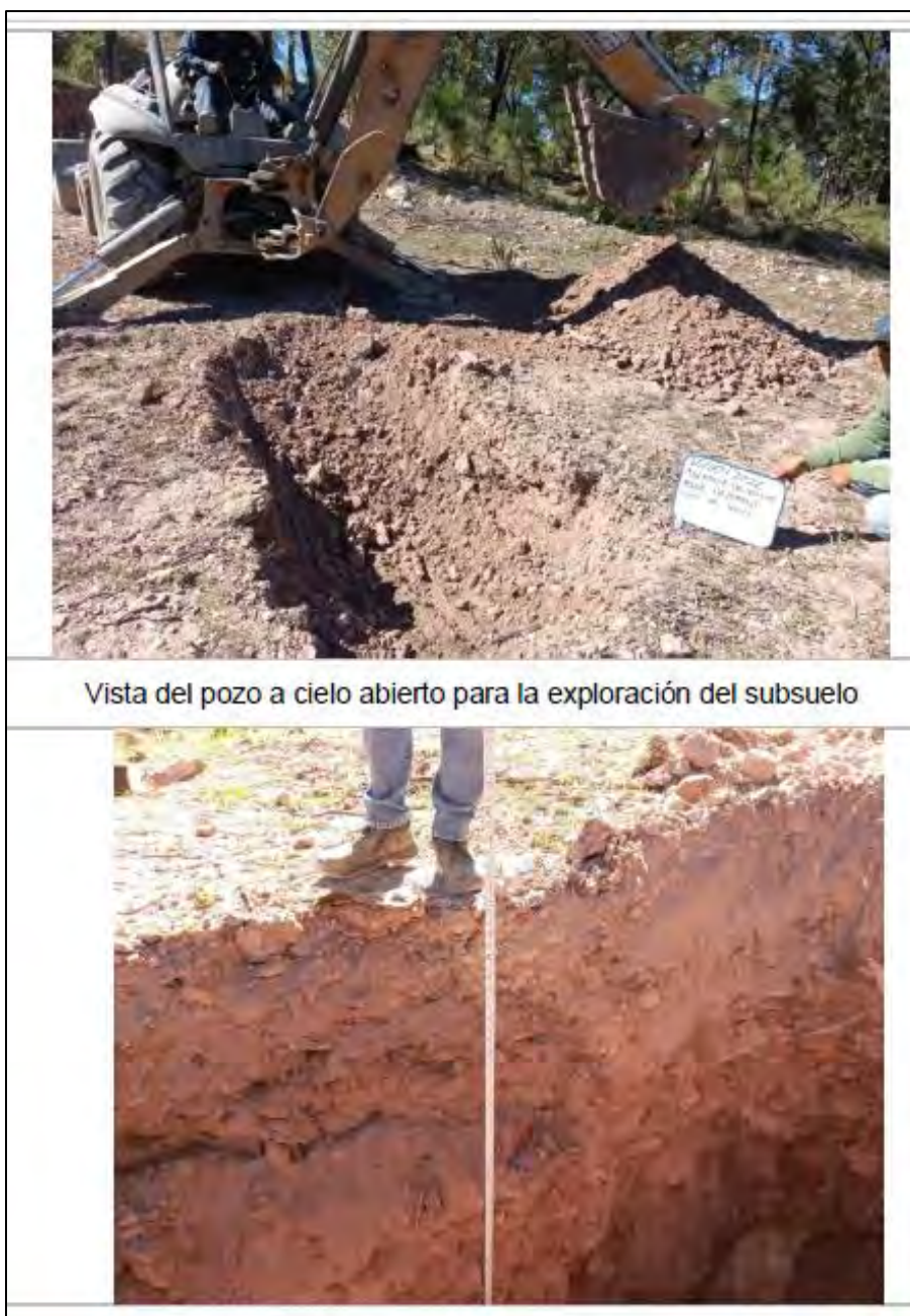
Figura III-13. Excavación para muestreo del suelo
