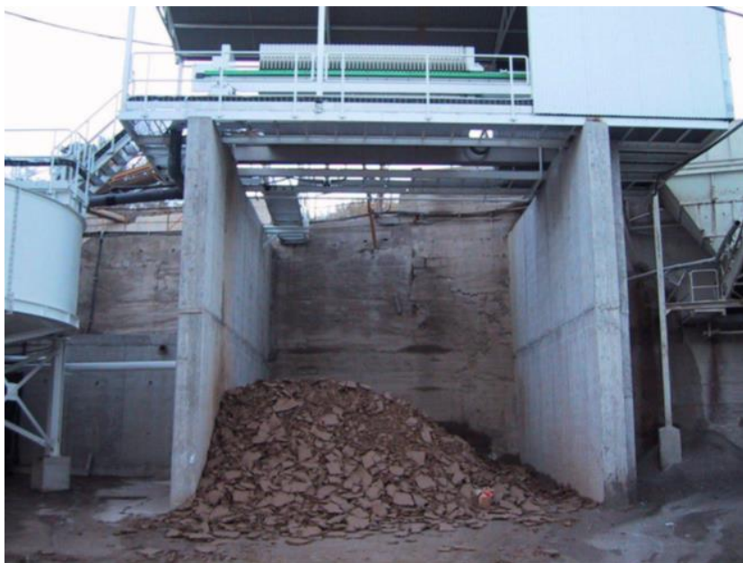
Figura II-8. Infraestructura y diseño para el filtrado de los jales
