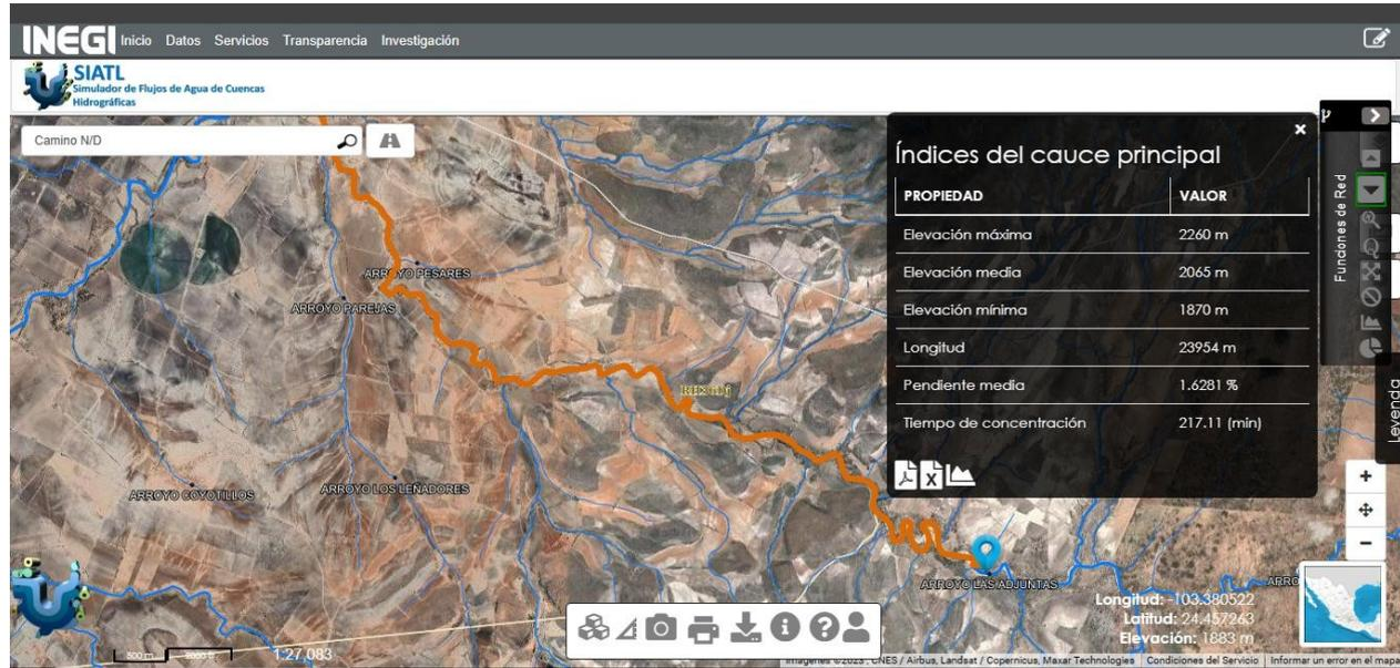
**Ilustración II. Parámetros de los elementos hidrográficos que se estimaron por medio del SIATL v4 (INEGI, 2018)**
