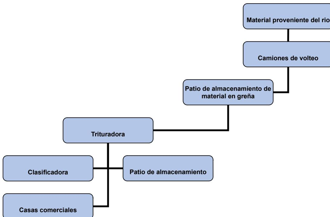
El proceso que comprende la extracción de la materia prima (material en greña) consta en extraer el material en greña del río mediante la utilización de una retroexcavadora modelo 4189-B-114MEC45, marca Michigan, después colocarlo en camiones de volteo para posteriormente trasladarlo a donde los clientes lo requieran.
