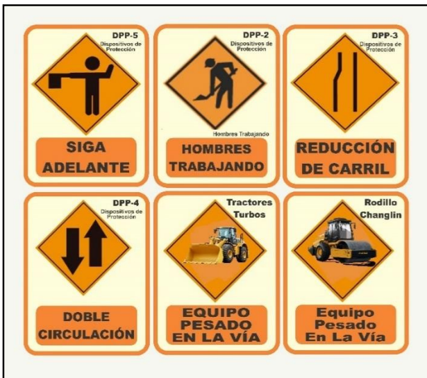
Ilustración II.2.11.1. Señalizaciones de hombres trabajando.
