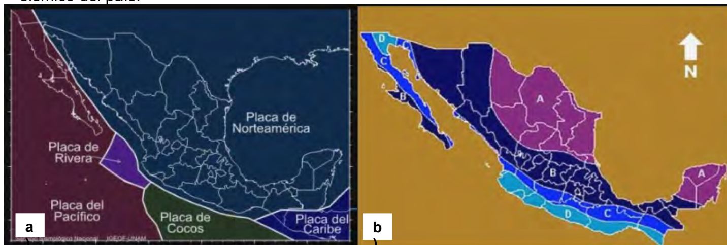
Figura 2.1.3. a) Zonas de subducción mexicana, donde se muestran las placas tectónicas de México. b) Zonas sísmicas de México, clasificadas de la A a la D, donde la primera es categoría de "bajo" riesgo y la última de muy "alto" riesgo de sismos. Fuente: SSN, Instituto de Geofísica, UNAM 2019.
