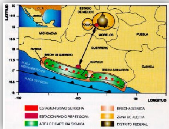
Fig.7.-Estaciones sismo-sensoras del sistema de alerta sísmica para el estado de Guerrero.
