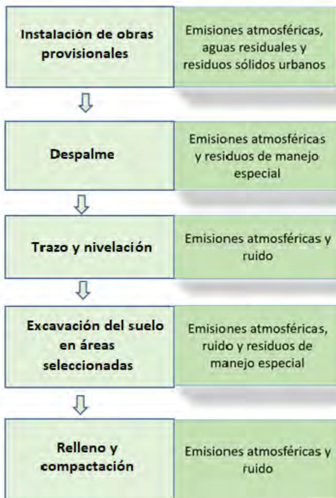
Figura II. 10. Flujograma del proceso de preparación de sitio.
