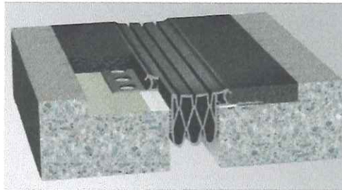
Figura. 18. Ejemplo de junta constructiva.
