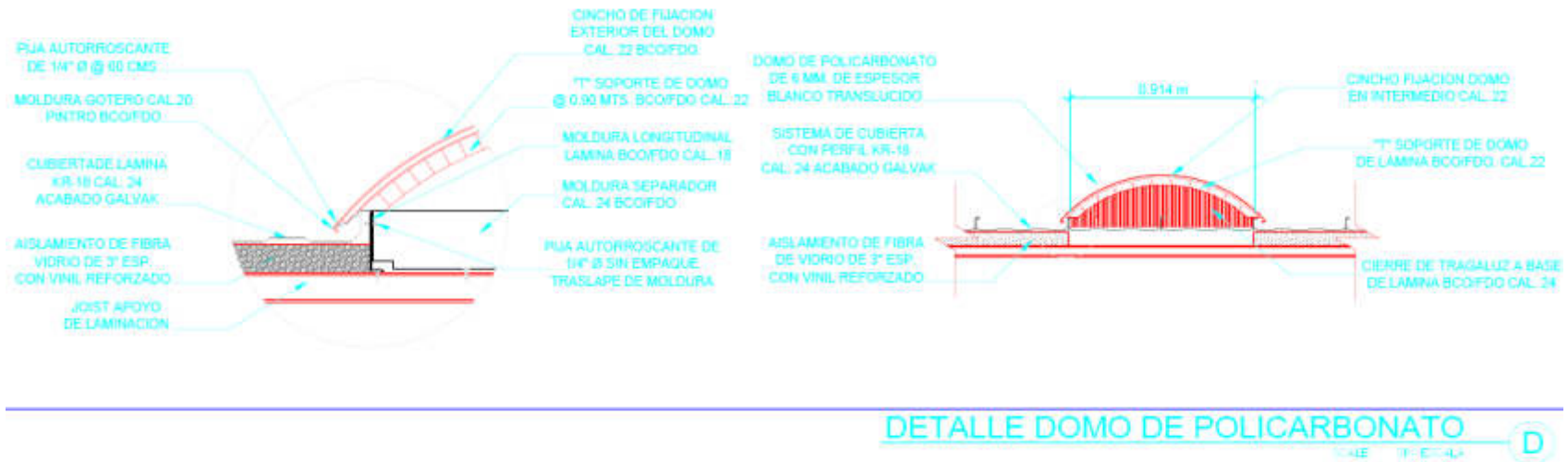
Figura II. 25 Detalle de instalación de Domo de policarbonato
