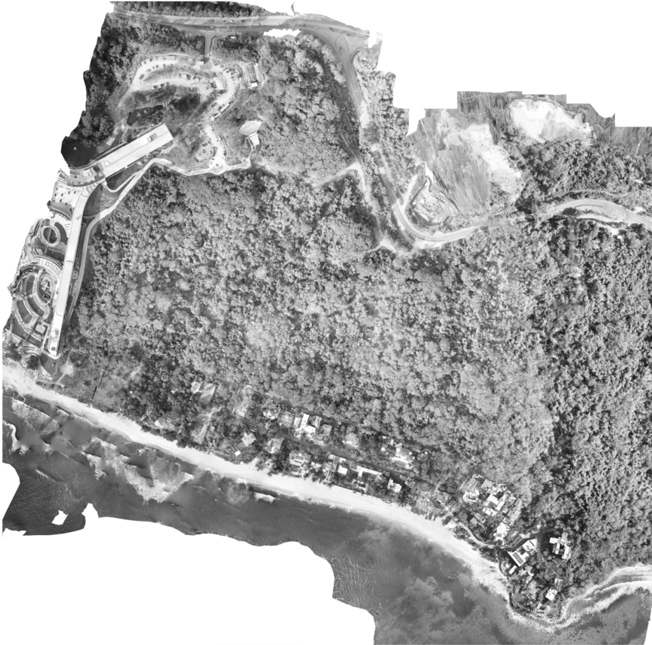
Ortofoto Digital del área de proyecto tomada con Dron DJI Phantom4 a 100 m de altura en abril de 2022 y formada en Drondeploy.
