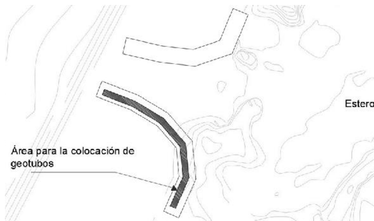
Ilustración 14. Área de colocación de geotubos en Boca norte uno.
