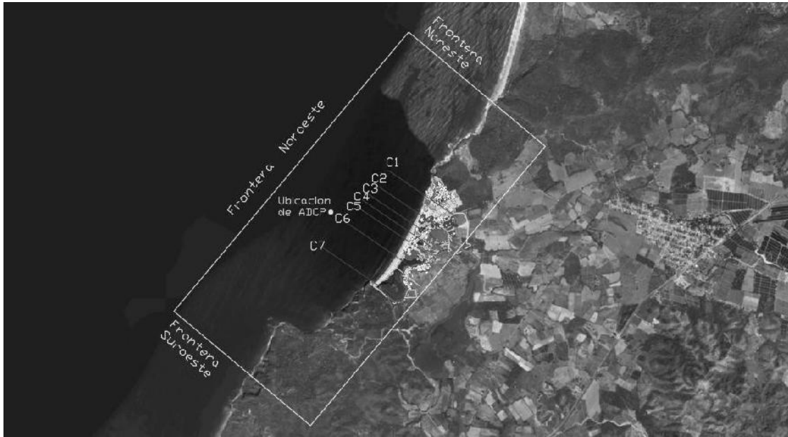
Ilustración 43. Fronteras (líneas blancas) del modelo de detalle, ubicación del Doppler (punto amarillo) y secciones de control (líneas rojas) sobre el dominio del modelo.
