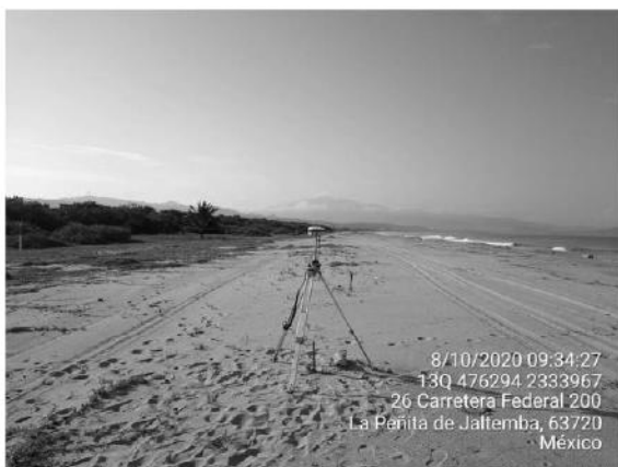
Figura IV.29. GPS base haciendo estación en vértice con coordenadas conocidas
