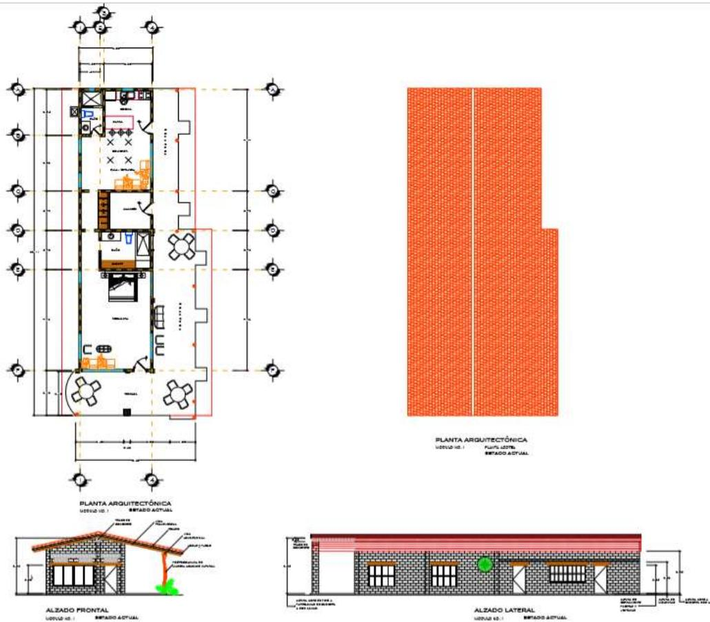
**Figura 11:** Plano arquitectónico del módulo I.
