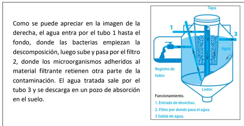
**Imagen II.1** Funcionamiento del Biodigestor Autolimpiable
