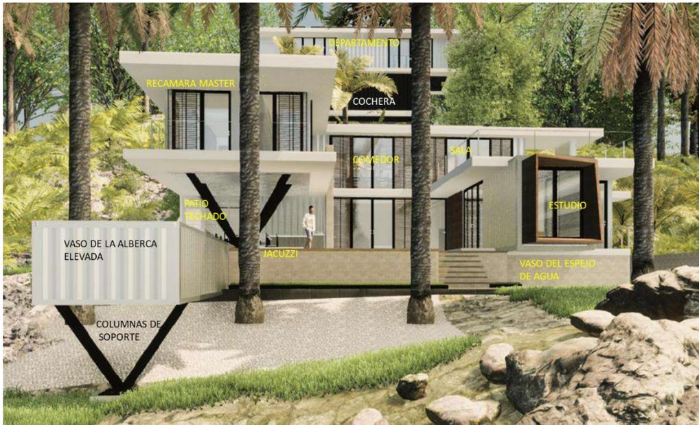
Estructura de concreto. Se trata de la construcción de columnas, (en el patio techado se sostendrá por una columna cuádruple en V como en la parte extrema de la alberca) traveses, firmes y losas con concreto premezclado. Se utilizarán camiones mezcladores, bombas para concreto y vibradores.
