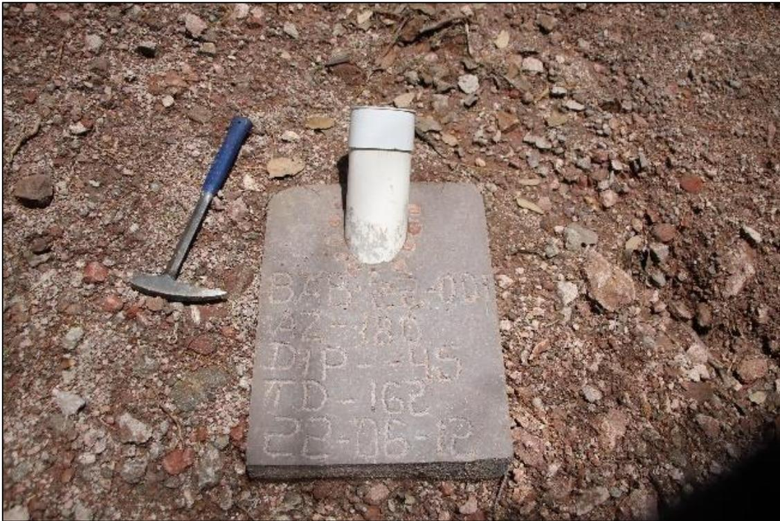
Figura 6. Imagen presentada como ejemplo del sellado de barrenos.
