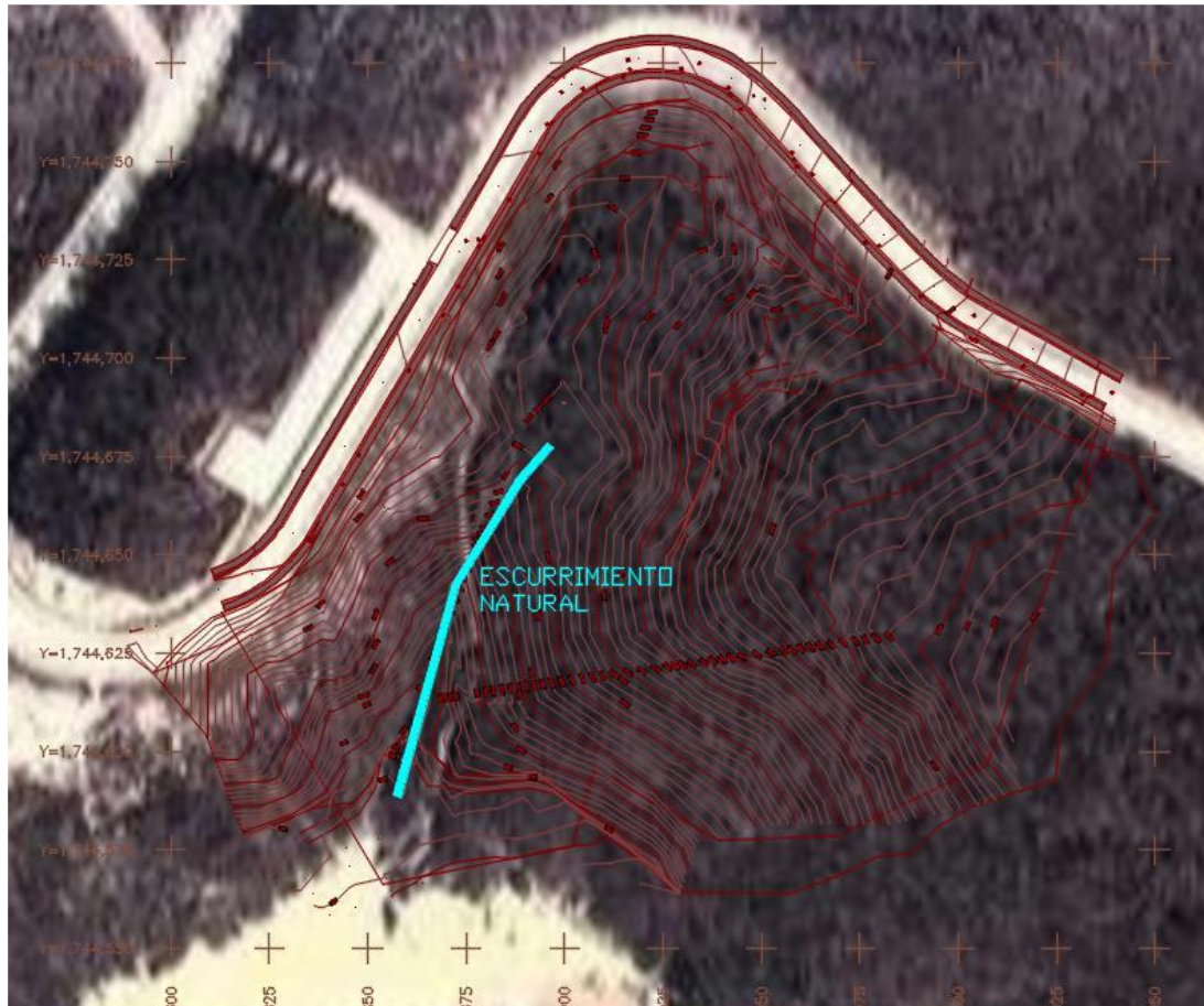
Imagen II.7.- Representación de la cañada donde se forma el escurrimiento pluvial, con salida al mar.
