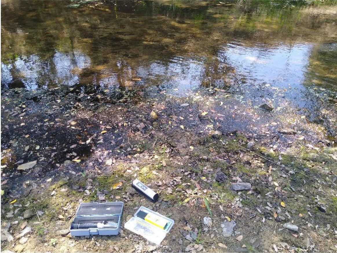
Figura 4.6 Equipo usado para tomar características físicas del agua.
