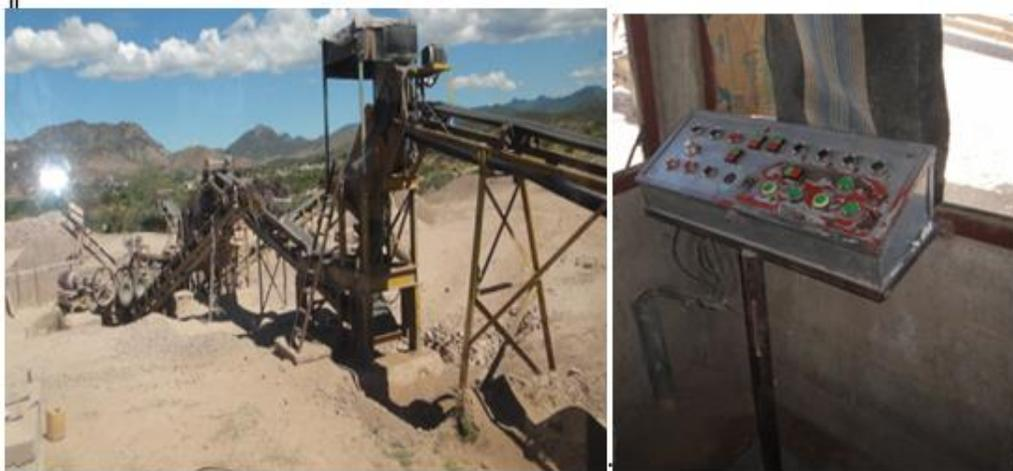
*Ilustración 6. Trituradora para producir grava y arena y tablero de control.*
