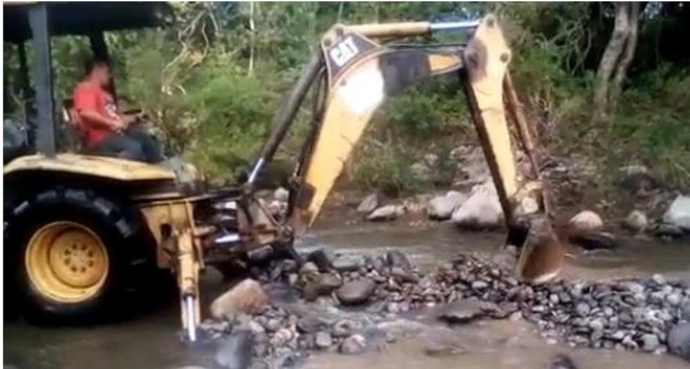
*Ilustración 14. Extracción y manejo del material pétreo con retroexcavadora.*
