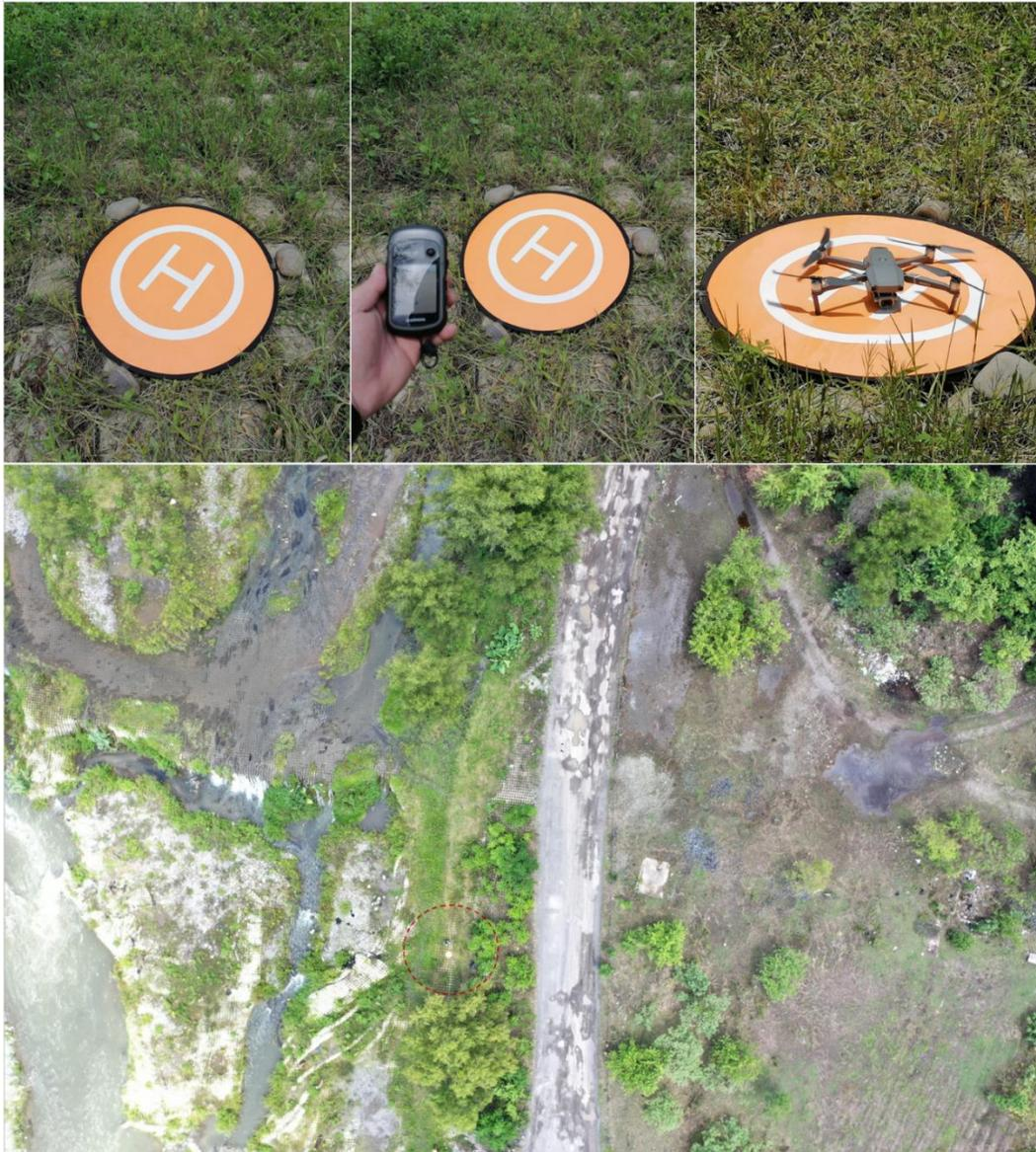
**Imagen IV.41. En cada punto de despegue se tomó una coordenada con la ayuda de un GPS y posteriormente, se tomó una fotografía aérea perpendicular con el Dron para tener una referencia espacial ubicando una diana de control.**
