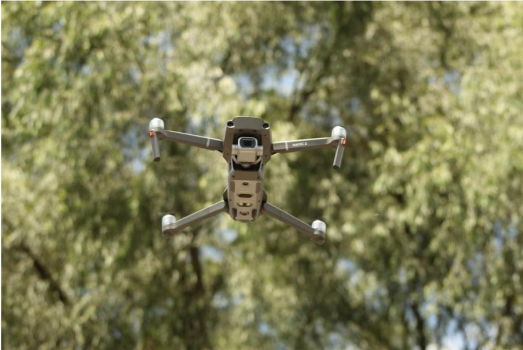
**Imagen IV.39. Equipo utilizado en el levantamiento de información (Dron DJI Mavic Pro 2).**
