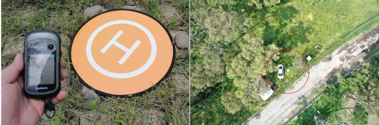
**Imagen 36. En cada punto de despegue se tomó una coordenada con la ayuda de un GPS y posteriormente, se tomó una fotografía aérea perpendicular con el Dron para tener una referencia espacial ubicando una diana de control.**
