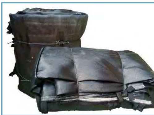
Figura II_ 24. Tubos de geotextil para el refuerzo del andador.
