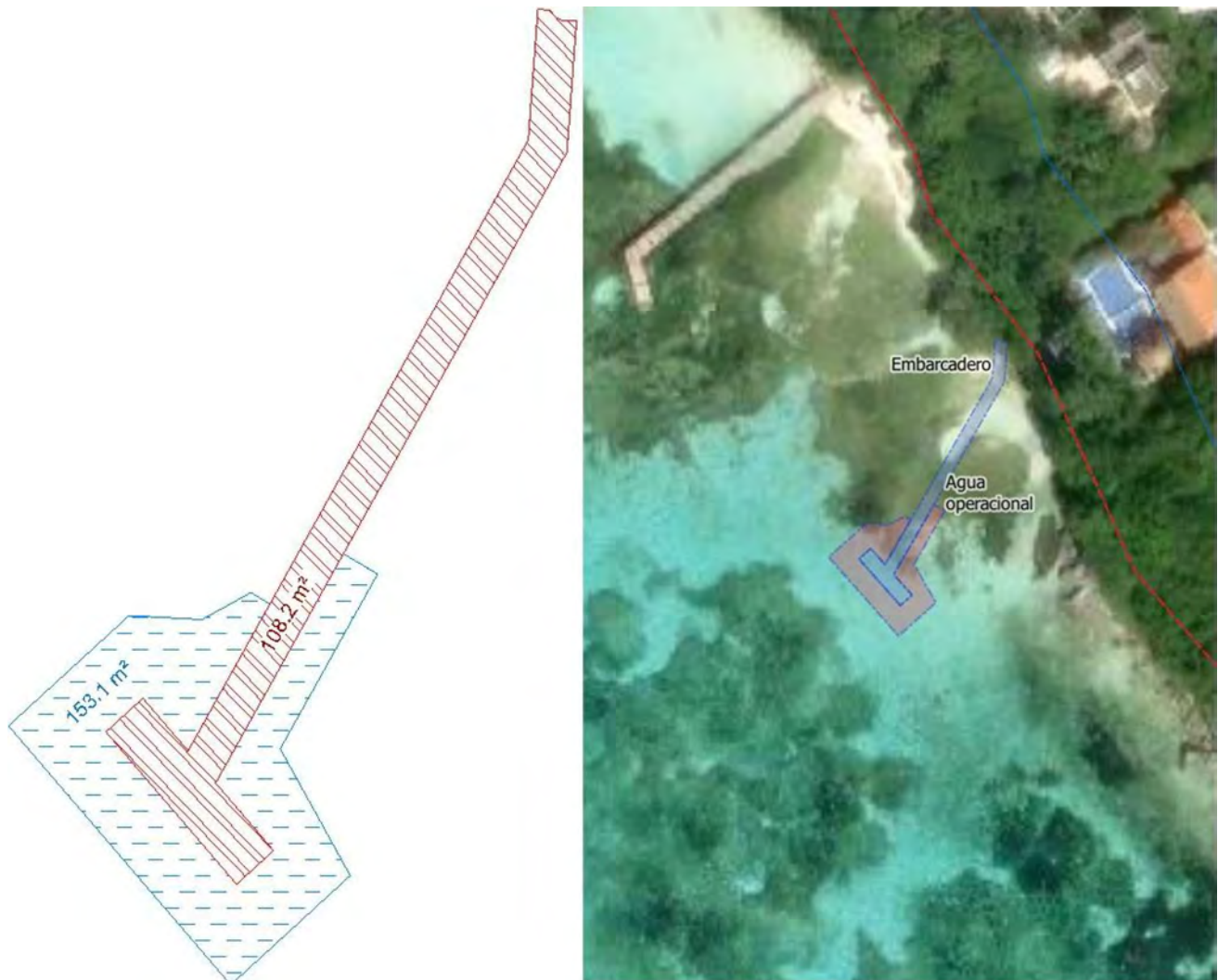
Figura 13. Zona de influencia del proyecto Embarcadero rústico La Joya se limita a su área de emplazamiento, por tratarse de una instalación de madera de operación pasiva, para el acceso de visitantes a la zona marina. La línea roja indica la Pleamar Máxima de la delimitación oficial de Zofemat.
